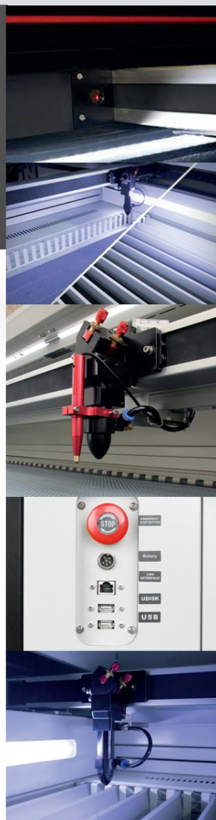
Machine de gravure et de découpe laser de haute précision LS 1490 Séries format 1400mm X 900mm. La LS 1490 vous apportera productivité, précision, vitesse et ergonomie. Elle est dotée d'un châssis tubulaire droit renforcé.
