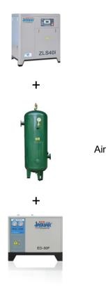
Découpe à l'air comprimé principalement utilisée pour la coupe de tôle d'acier mince:Il est préférable d'utiliser notre option (pression stable de 1,2MPa, le déplacement de 1000L/min). Dispositif de filtration à 3 niveaux (Q.P.S) équipé d'un sécheur d'air (capacité de traitement 2,5Nm2/min), un réservoir de stockage d'air (0,6 m3). Il est recommandé de sélectionner le filtre à particules fines pour un résultat de coupe meilleur et une durée de vie des lentilles prolongée.
