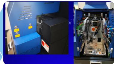
La Galaxy BETA 1000 possède une résistance de chauffe de la tête d'impression qui permet à la tête d'éviter son usure prématurée à température froide. Cette fonction confère à la tête une encre toujours fluide à bonne température.
