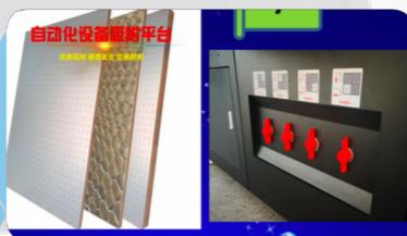
Table d'aspiration avec traitement de surface, plate-forme alvéolaire résistante à la charge, panneau trous fraisés bicouche. Quatre zones A, B, C et D avec vannes sectorielles
