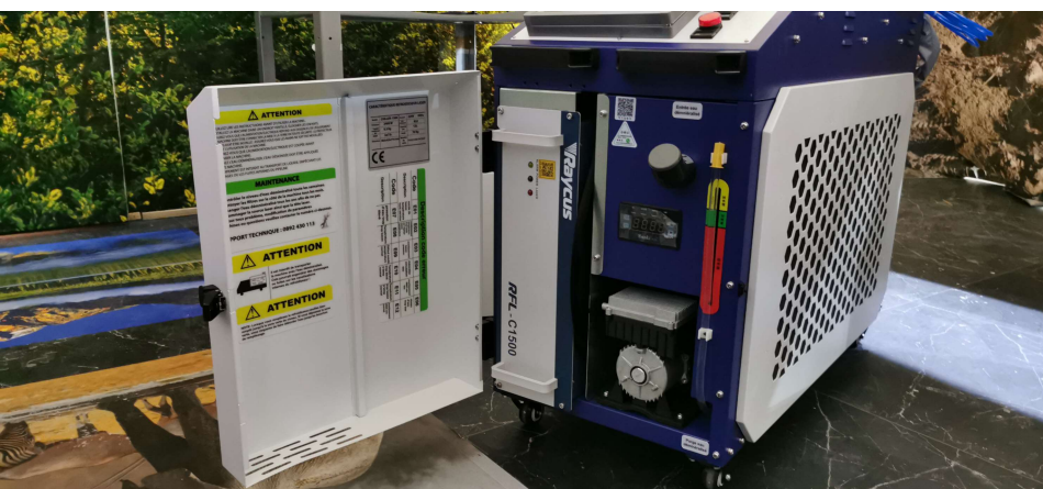
Tiroir «easychange» pour source laser fibre Système de vidange de liquide de refroidissement simple avec tube souple amovible
